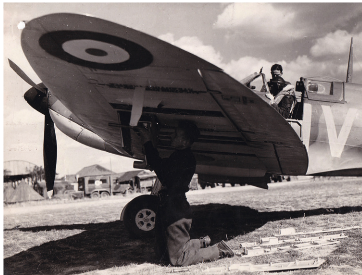
Spitfire Mk.Ia ve finální podobě, s plným pancéřováním včetně pancéřování čelního štítu, vrtuli De Havilland 5/20, vytápěním kulometů s výdechy horkovzdušného topení na spodní ploše křídla, reflexním zaměřovačem GM2, pozdějším typem anténního stožárku a Pitotovy trubice a zpětným zrcátkem.
